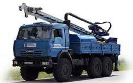
**Установка буровая гидрофицированная средней серии на автомобильной базе типа УБГ-С-45 "Барс".**
