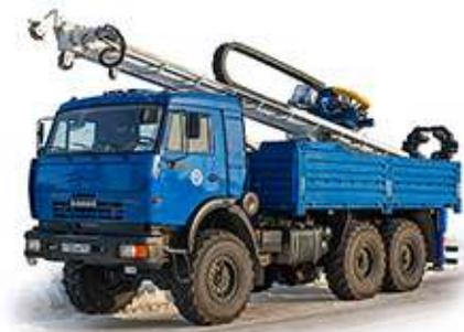
**Установка буровая гидрофицированная средней серии на автомобильной базе типа УБГ-С-35 "Беркут".**
