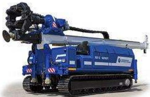
Компания "СБТ" представляет гидрофицированную буровую установку **УБГ-С-30 "Беркут"** на гусеничном ходу, предназначенную для бурения инженерных скважин в породах I-XII категорий.
